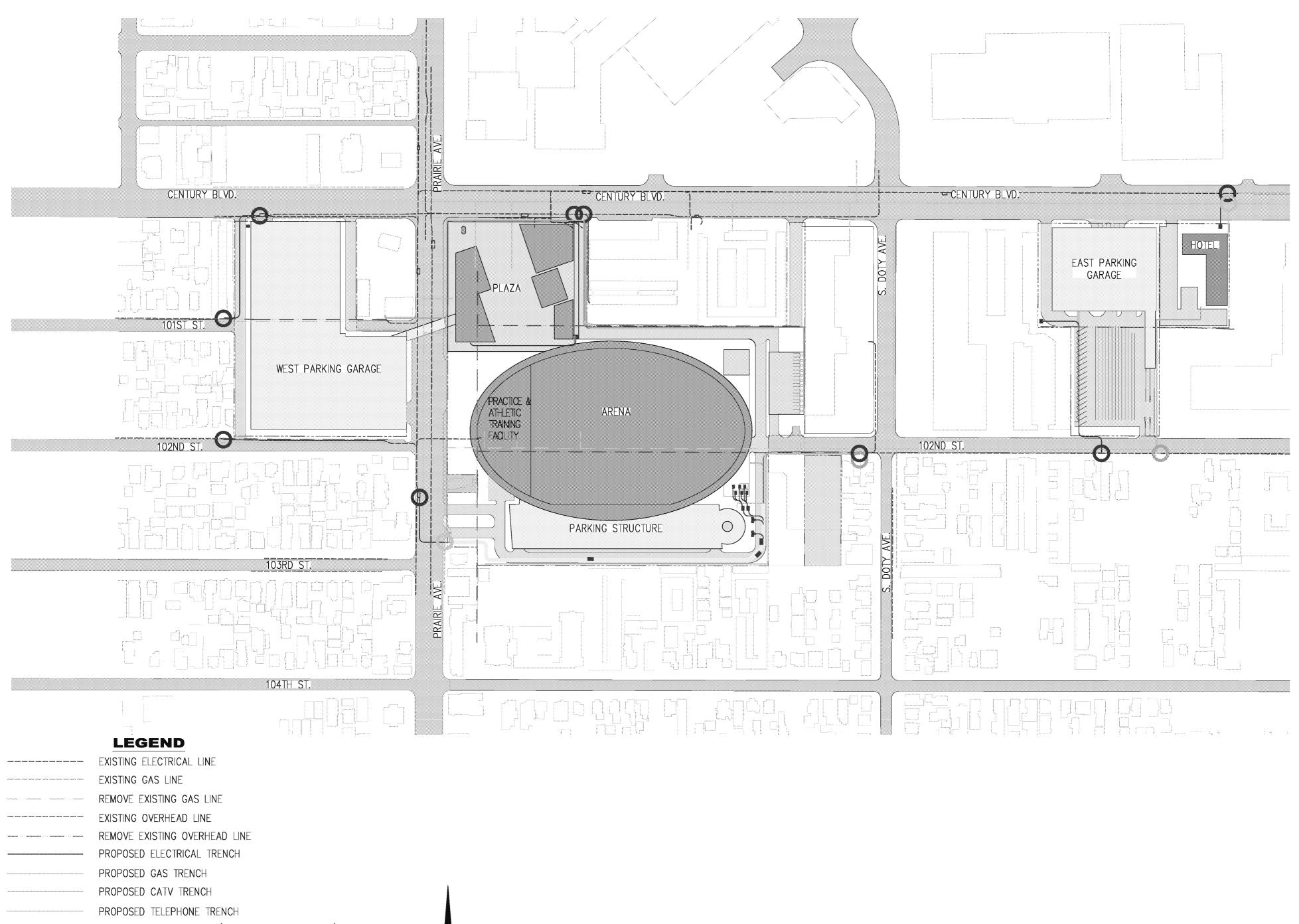
PROPOSED JOINT TRENCH (ELEC., GAS, CATV, TELE.)
